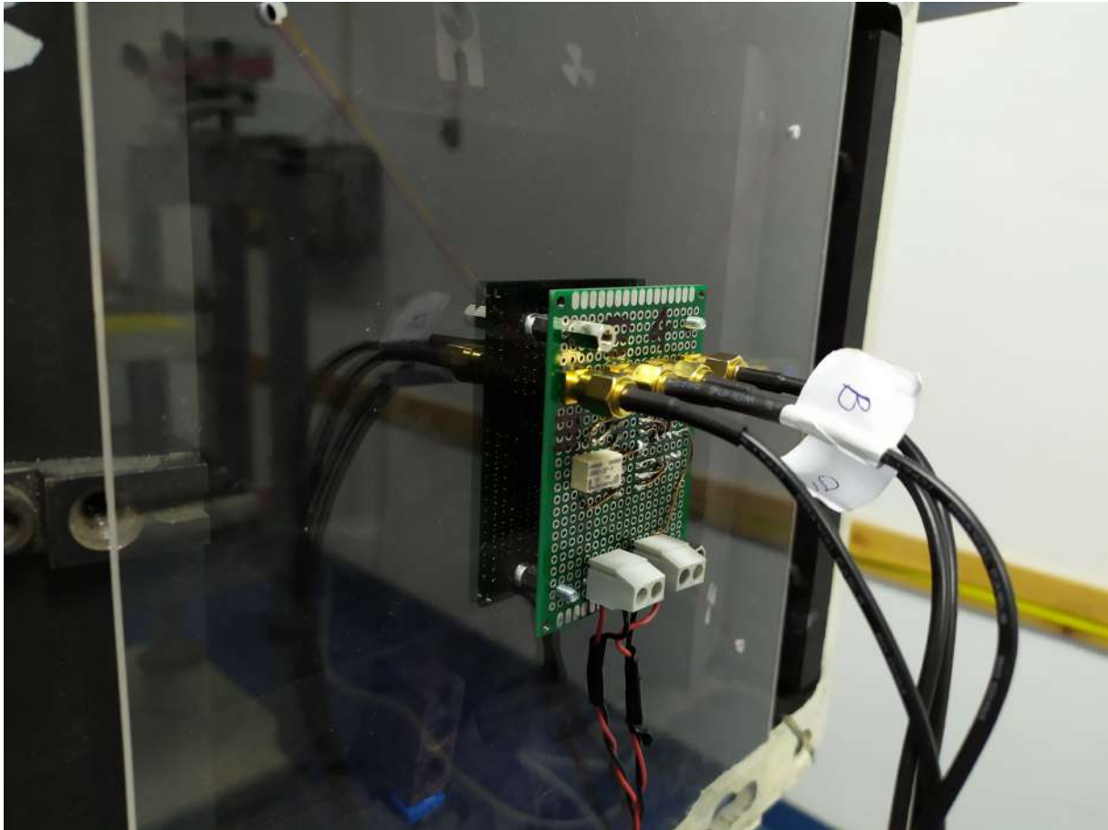
Slika A.4: Fotografija sistem za merenje EPAD-a u režimu visoke osetljivosti montiranog preko pleksiglasa na usta kolimatora u Laboratoriji za zaštitu od jonizujućeg zračenja na Institutu za nuklearne nauke „Vinča“.
